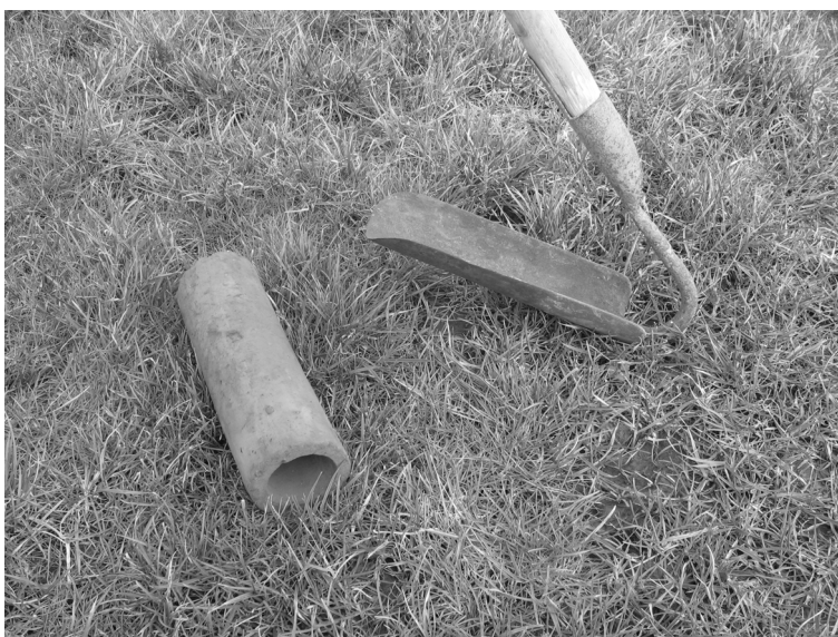
De schoeper waarmee het bed voor de draineerbuizen afgewerkt werd.
