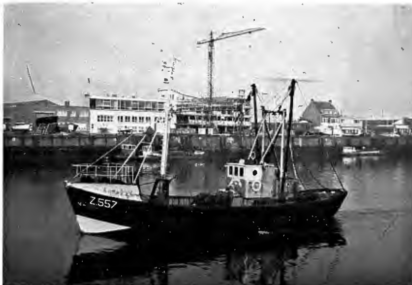
Kleine middenslagtreiler (1963) met, achter de stuurhut, de uitrusting voor bokkevisserij.
