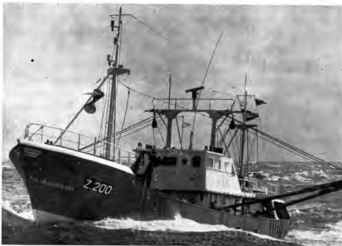
De "Tijl Uilenspiegel", grote diepzeetreiler - staal - gebouwd 1972 - 143 brutoton - motor 610 P.K. - alle navigatieinstrumenten.
