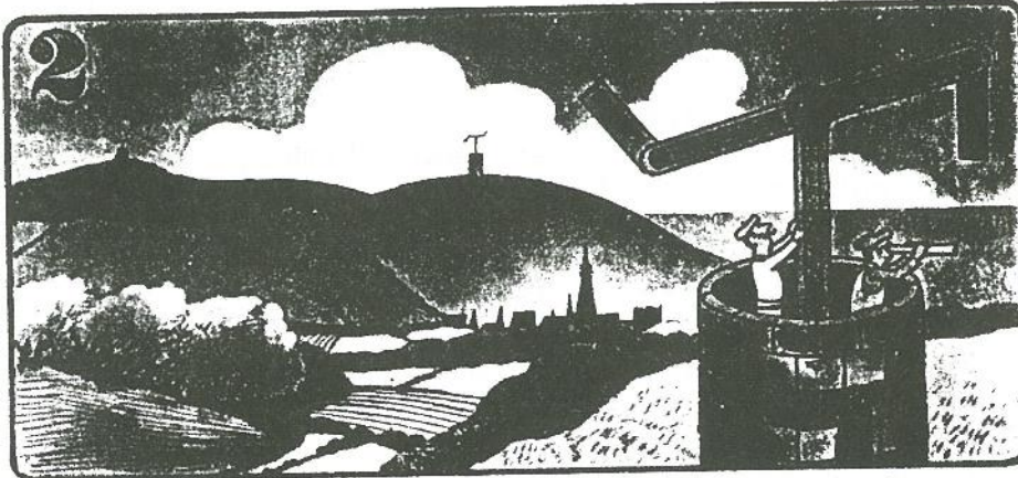
Dit was een van de eerste sein-toestellen: de semafoor. Deze seinmast had beweegbare armen; een bepaalde stand gaf een letter of cijfer weer. De semaforen stonden
